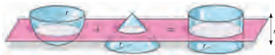
Sección de la semiesfera ( A_1 ) Sección del cono ( A_2 ) Sección del cilindro ( A_3 )
