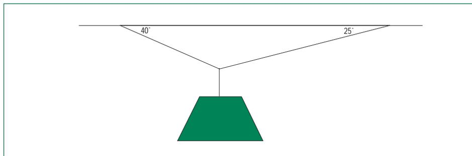
Sugerencia: descomponer las fuerzas que se ejerce sobre los cables en sus respectivas componentes horizontales y verticales.
