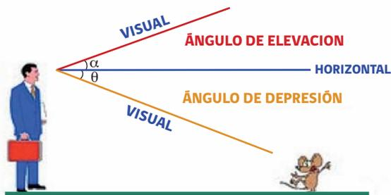
El **ángulo de elevación**  $\alpha$ , está formado por la línea horizontal y la línea que une el punto de mira con el objeto observado por sobre la línea horizontal.
