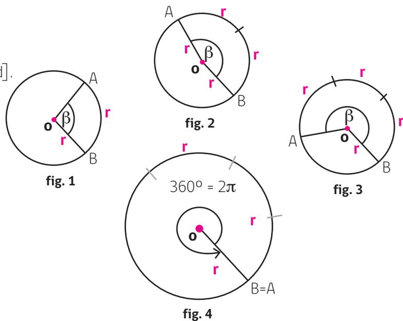
Obsérvese que en el caso de la figura 4, un ángulo de  $360^\circ$  subtiende un arco de circunferencia completo de medida  $2\pi r$  unidades, al dividir esta longitud por la medida  $r$  del radio, se obtiene  $2\pi$ , es decir  $360^\circ \leftrightarrow 2\pi$  [rad]. Esta equivalencia permite establecer que  $180^\circ \leftrightarrow \pi$  [rad]
